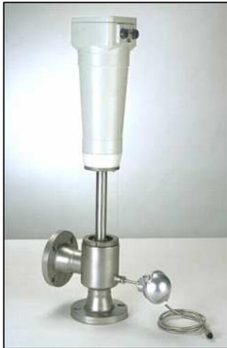
Die Messzellen DC 40E bzw. DC 40D eignen sich für die kontinuierliche Viskositätsmessung in Prozessanlagen mit mittlerem bzw. hohem Druck und hohen Temperaturen. Zur direkten Temperaturmessung in der Messsubstanz ist ein Querstutzen für die Einbringung eines Pt 100-Tempersensors vorbereitet. Die Messzelle DC 40D ist mit einem Doppelmantel zur Temperierung ausgestattet.
