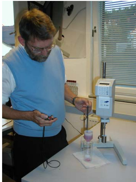
Abb. 3: Messungen im Labor mit R 180 und Auslaufbecher
